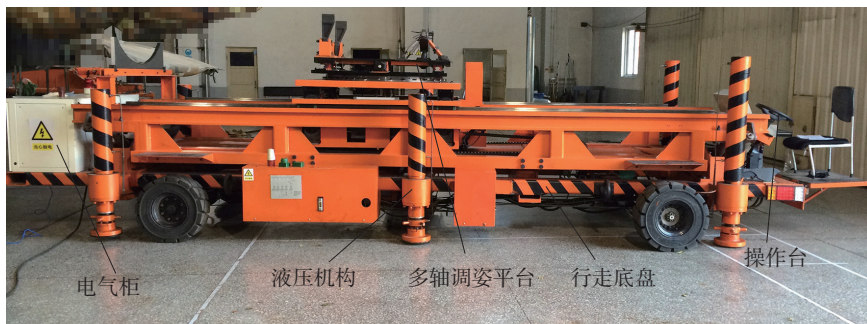
图4 航空发动机数控安装架车
